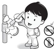
※ При утечке газа контрольная лампа комнатного контроллера и дисплей комнатной температуры будут отображать номер 97, а все лампочки контроллера будут мигать. В течение этого времени очень опасно использовать зажигалку, газовую плиту или переключатель вентилятора. Сперва, откройте окно для проветривания, и проведите тест на утечку газа при помощи мыльной воды. Если это не утечка газа, нажмите кнопку «питание»/«повторный запуск» на регуляторе температуры в помещении.
